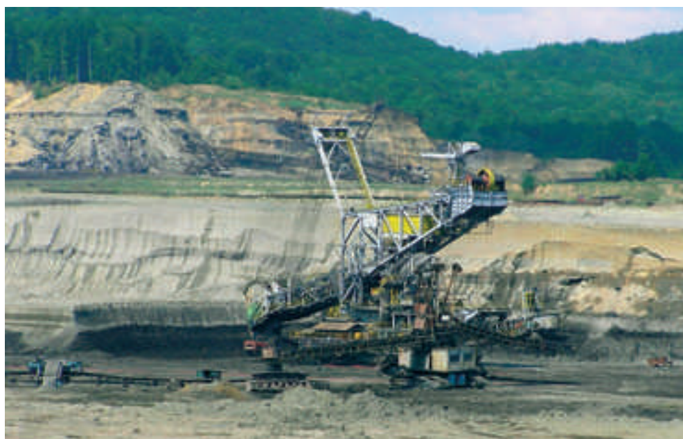
Kolesové rýpadlo nasazené ve smíšeném řezu
